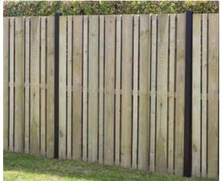
ÉCRAN «TORINO» 180 X 180 CM sapin rouge autoclavé classe 3, épaisseur 50 mm, panneau fabriqué avec une alternance de planches larges et étroites pour une occultation totale, visserie inox - Réf. : BOI09071
